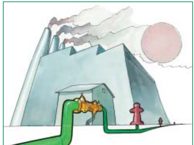
Plaatsing van een terugstroombeveiligiger in een brandweersysteem.
