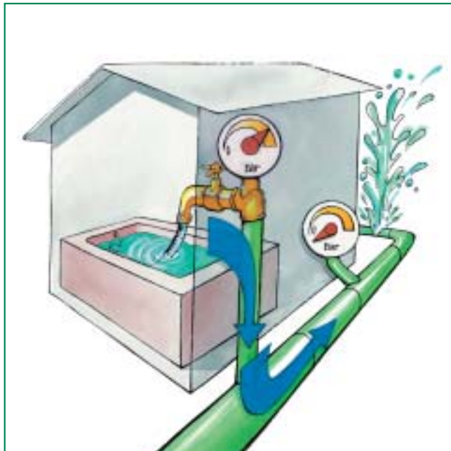
Plaatsing van een terugstroombeveiligiger in een brandweersysteem.
